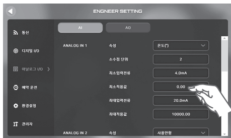
13. 사용하고자 하는 단자의 최대 적용값을 설정합니다. 최대입력 전류에 대응하는 최대 적용값입니다. 사용하고자 하는 단자의 최대 적용값을 터치합니다.
