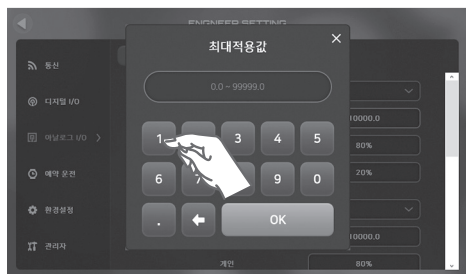
14. 키패드가 나타나면 원하는 최대 적용값을 입력하고 OK 버튼을 터치해 변경된 최대 적용값을 저장합니다. 공장 출하시 설정값은 10000 입니다.
